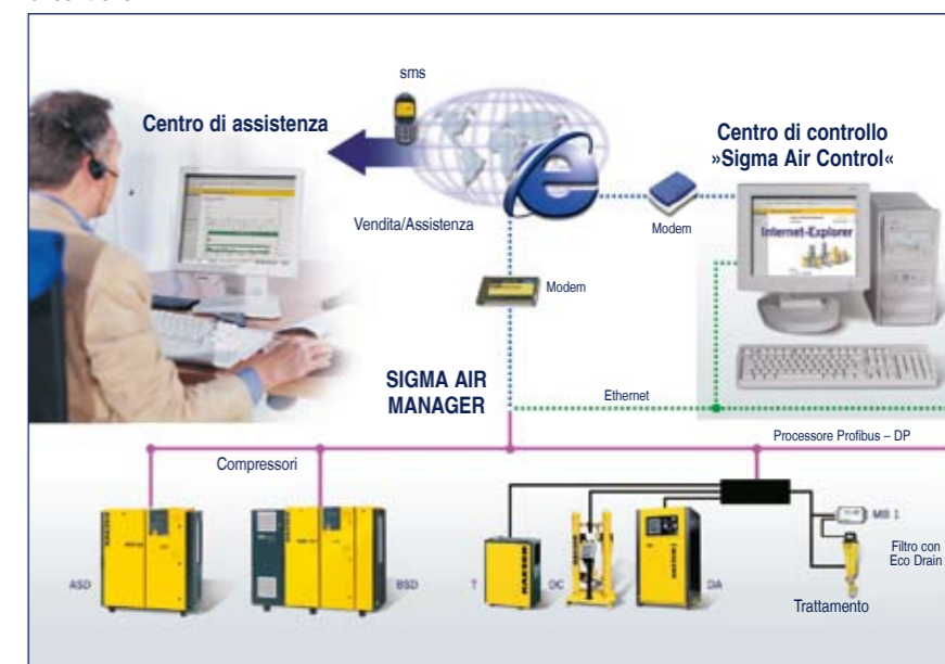
Il Profibus consente la rapida trasmissione dei dati dalla stazione dei compressori ai sistemi informatici di controllo
