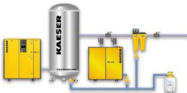
Essiccatori a ciclo frigorifero con regolazione a risparmio energetico SECOTEC
