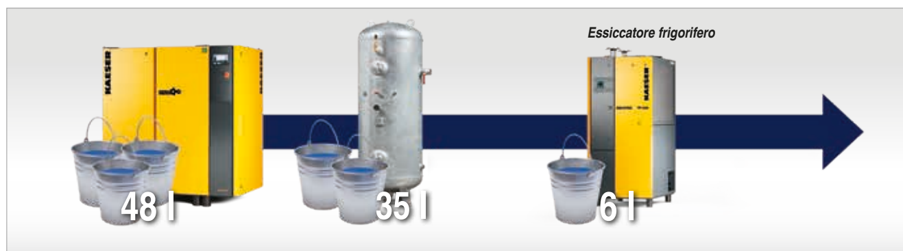
Fig. 1: Nelle fasi di produzione, stoccaggio e trattamento dell'aria compressa si genera la condensa (dati relativi a 10 \text{ m}^3/\text{min} , 10 \text{ bar}_{\text{abs}} , 8 h, 60\% F_{\text{rel}} e 20 \text{ }^\circ\text{C} )
