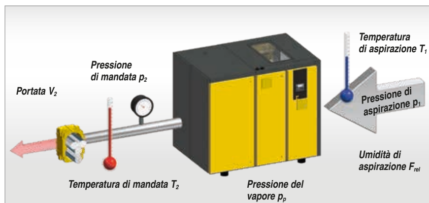
Fig. 1: Misurazione della portata conforme a ISO 1217, allegato C (DIN 1945, allegato F)
