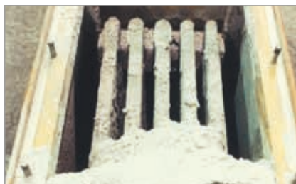
Fig. 2a: Filtro per ambienti polverosi (lato di aspirazione)
