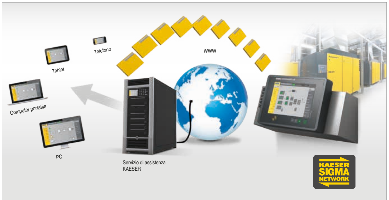
Fig. 7: La spiccata connettività del master controller contribuisce notevolmente all'efficienza di una stazione d'aria compressa
