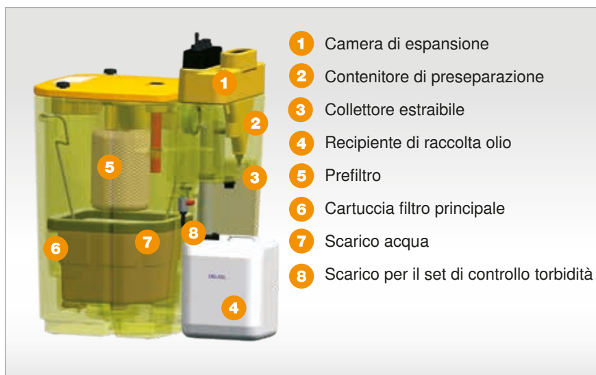
Fig. 2: Sistema di separazione gravitazionale della condensa (schema funzionale)
