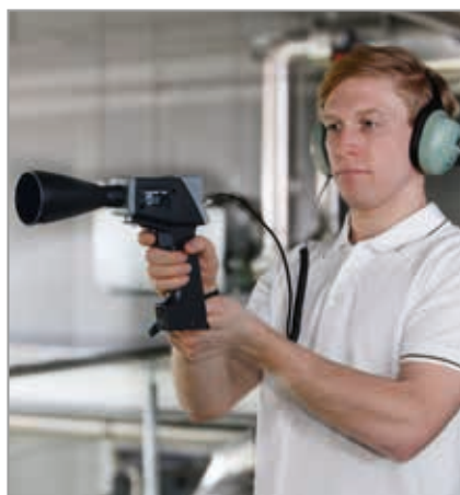
Fig. 4: Rilevamento perdite con ultrasuoni
