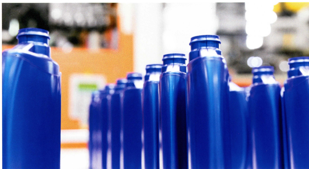
Le bottiglie di plastica escono tutte in fila dalla macchina di estrusione-soffiatura
