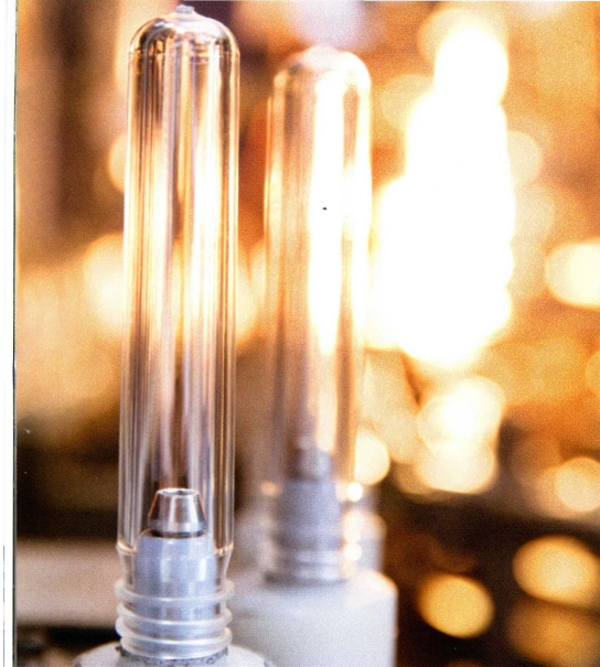
Il primo passo nel processo di iniezione-soffiaggio è la preforma (parison)
