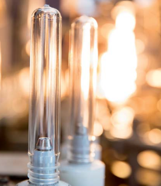
Il primo passo nel processo di iniezione-soffiaggio è la preforma (parison)
