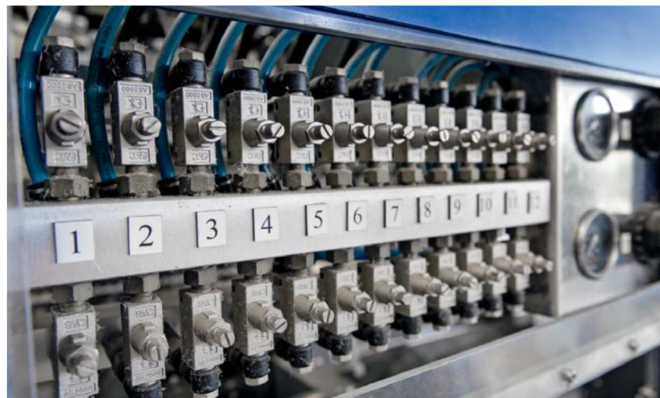
Controllo dell'aria di supporto per la testa del parison
