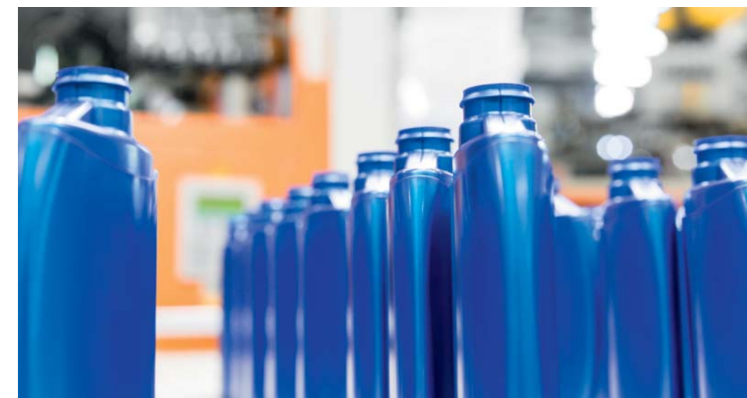
Le bottiglie di plastica escono tutte in fila dalla macchina di estrusione-soffiatura
