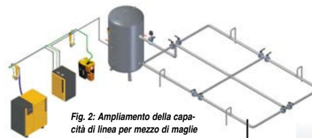
Fig. 2: Ampliamento della capacità di linea per mezzo di maglie intermedie
