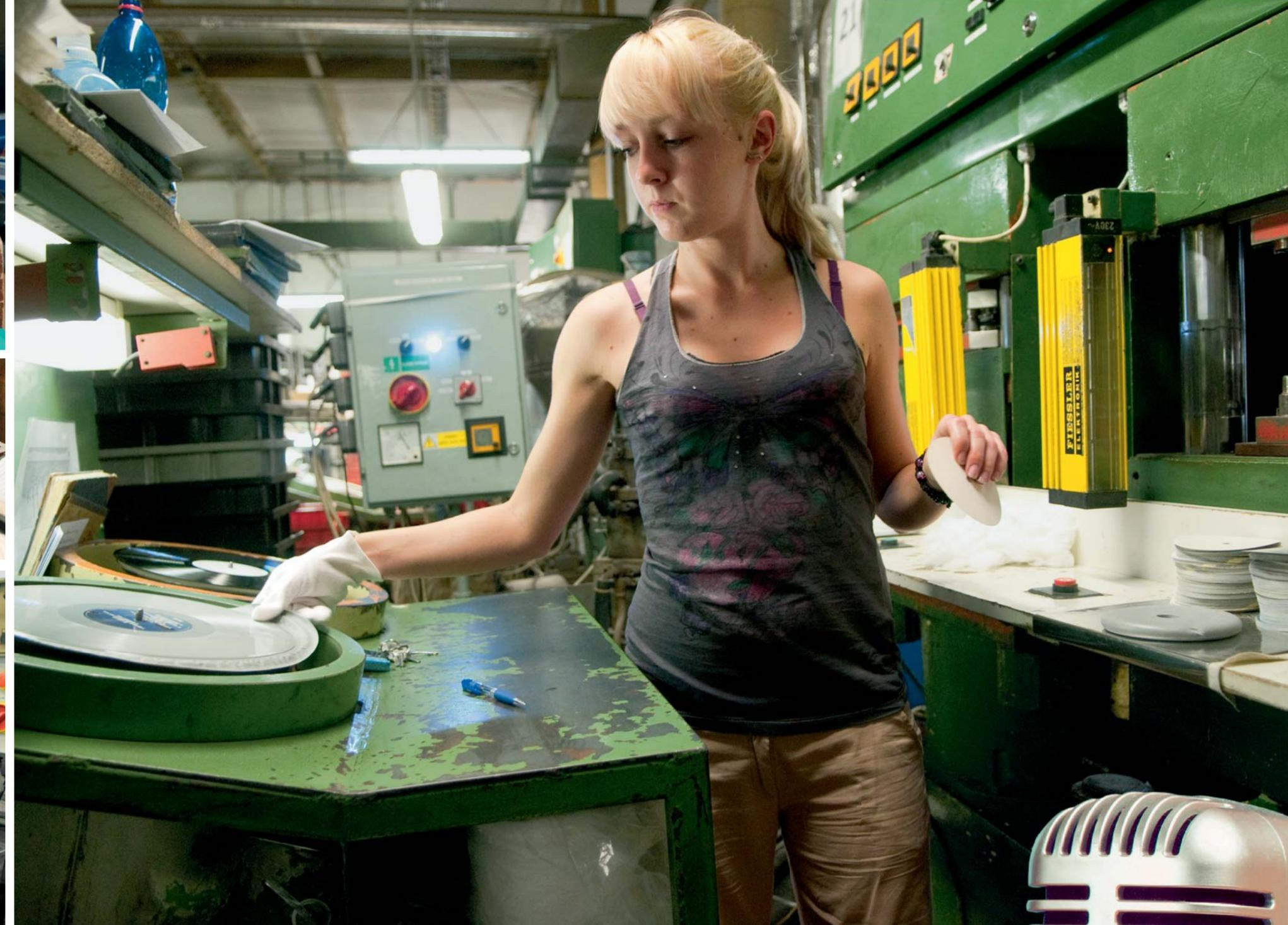
stampo. I dischi consistono di cloruro di polivinile (PVC) a cui si aggiungono circa 20% di acetato di polivinile (PVAc) e altri additivi. La materia prima è una sostanza trasparente lattiginosa e la cui colorazione è ottenuta mediante aggiunta di appositi coloranti.
