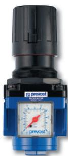
I regolatori **ALTO** permettono di regolare la pressione in funzione degli utilizzi. Il loro funzionamento a membrana e a molla assicura una pressione in uscita costante, conforme al valore selezionato. Proteggono gli utensili pneumatici dalle sovrappressioni e riducono il consumo energetico. Regolatore a membrana, di tipo progressivo. Pressione compensata dalla valvola di regolazione.
