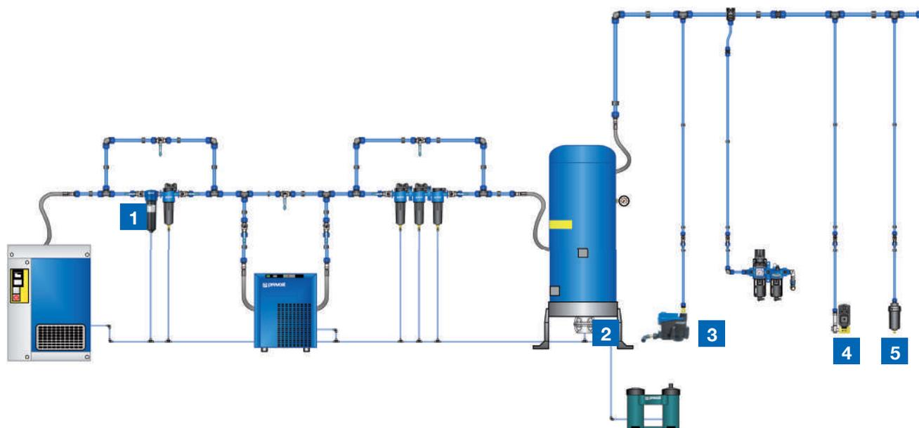
L'installazione di scaricatori è il complemento indispensabile per una buona filtrazione dell'aria compressa. Una rete correttamente equipaggiata garantisce l'efficienza degli utensili pneumatici e la qualità del lavoro eseguito.
