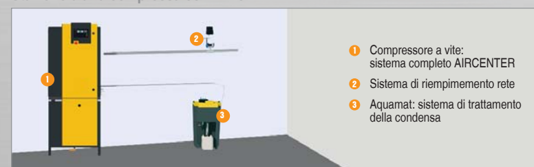
Stazione d'aria compressa con AIRCENTER
