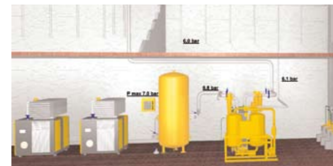
Fig. 3: Calo di pressione in un sistema d'aria compressa
