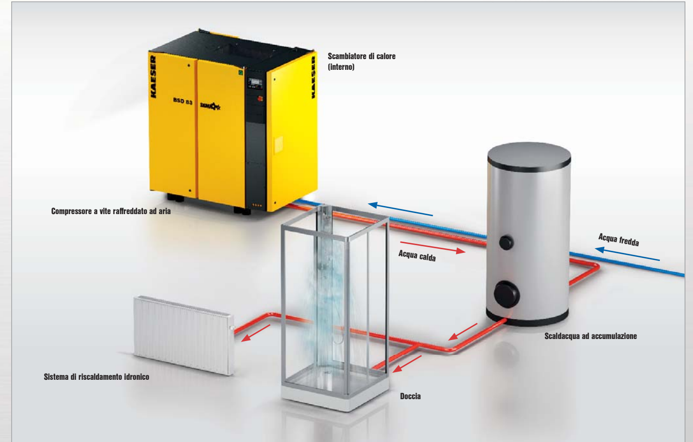
Foto: Schema del sistema di recupero del calore
