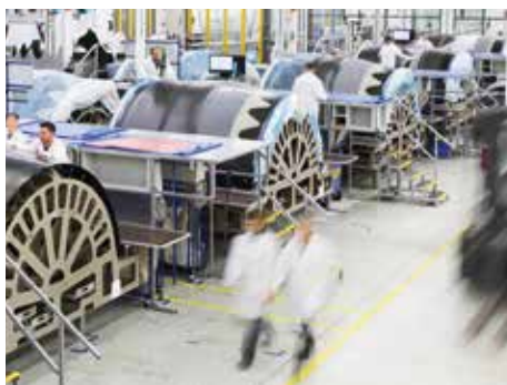
Nella camera bianca vengono utilizzati fino a 1000 strati di fibra di carbonio per realizzare le carenature del motore.
