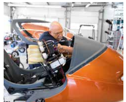
Montaggio finale della cabina di pilotaggio: è qui che vengono assemblate e collegate le apparecchiature avioniche dell'aereo.
