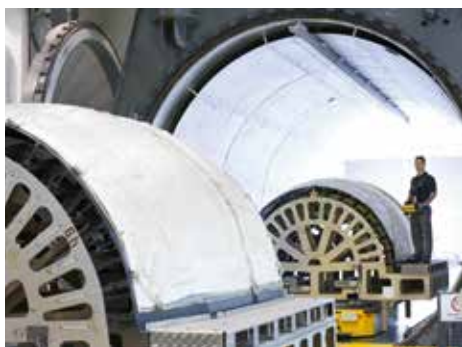
All'interno dell'autoclave le cappature dei motori acquistano rigidità e si conferisce ai materiali le loro caratteristiche finali.
