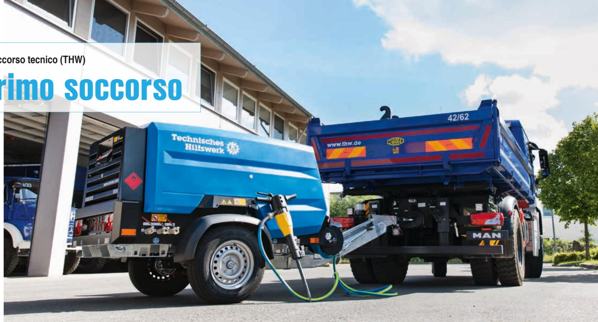
specifica per l'applicazione, in relazione al fabbisogno di corrente e alla pressione di esercizio impostata. L'utente può impostare la pressione massima (p) in modo continuo con incrementi di 0,1 bar tra 3 e 7 bar. L'impostazione della pressione è particolarmente apprezzata quando si utilizzano tubi flessibili lunghi.
