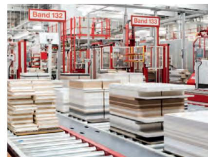
*L'aria compressa è necessaria durante l'intero processo produttivo: ad es. per il trasporto dei pannelli di legno.*
