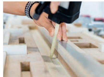
*... e nell'applicazione di adesivi multicomponente.*
