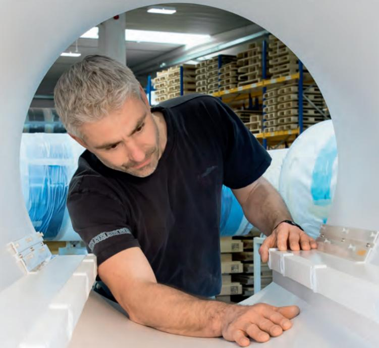
*I tubi per tomografi computerizzati sono rivestiti con una vernice speciale.*
