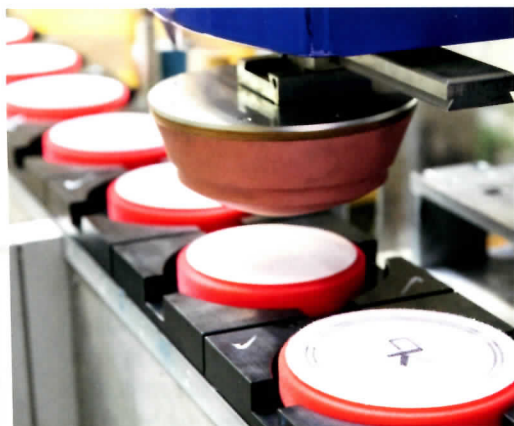
Nella produzione delle mole di lucidatura quasi tutte le macchine vengono azionate con aria compressa.
