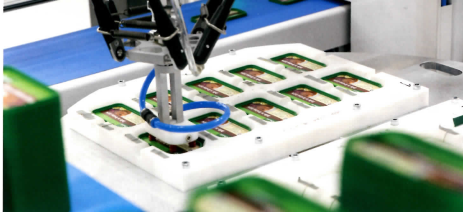
L'aria compressa serve anche per il trasporto e l'espulsione dei pezzi.
