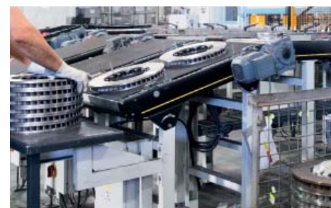
Piste frenanti caricate a mano nella fonderia di alluminio completamente automatica
