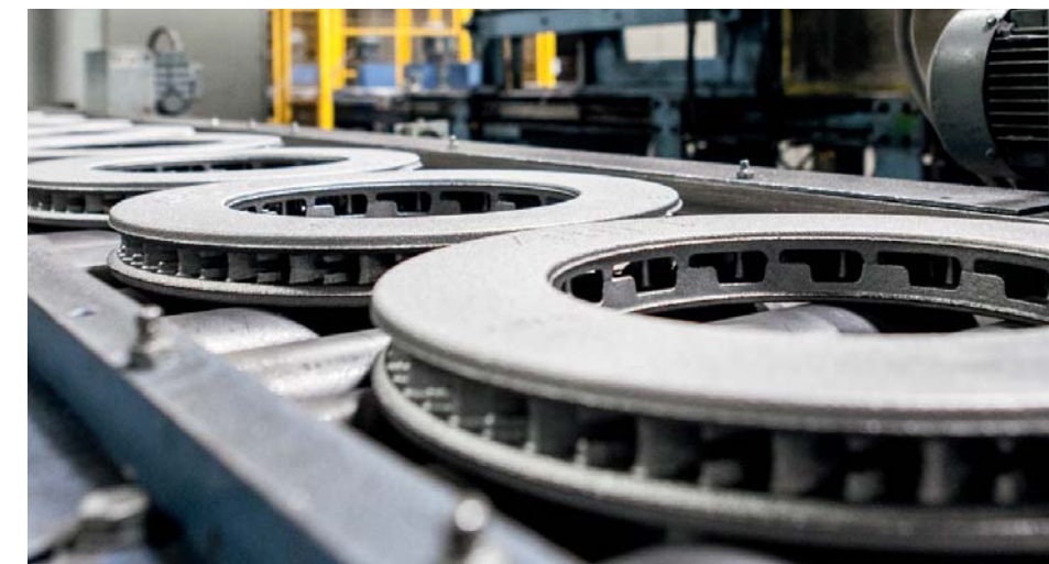
Elementi grezzi delle piste frenanti sul nastro trasportatore
